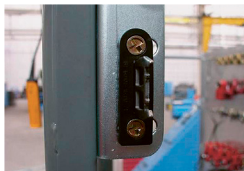
4 Empêcher un mauvais usage, par exemple en fixant l'actionneur de l'interrupteur de sécurité par soudage, par rivetage ou avec des vis non dévissables (fig. ci-dessus), en perçant ou en colmatant les têtes de vis ou en les bouchant avec des billes d'acier.
