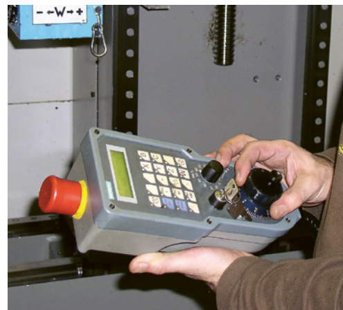
6 Molette de consigne électronique avec bouton d'arrêt d'urgence
