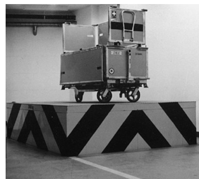
6 Des tabliers empêchent les personnes non autorisées d'accéder sous la plateforme.
