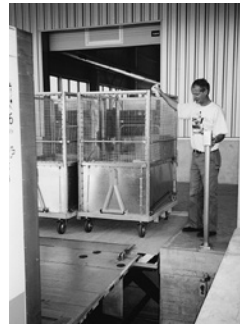
3 Cet opérateur dispose d'une bonne visibilité pour l'abaissement et l'élévation de la plateforme.
