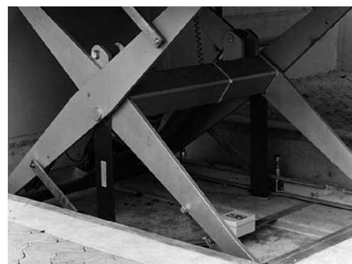
9 Avec les béquilles dépliées, le personnel d'entretien est protégé contre un abaissement involontaire de la plateforme.
