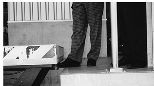
8 Les listeaux de contact évitent qu'une personne inattentive se trouvant à proximité immédiate de la plateforme ne se coince le pied.
