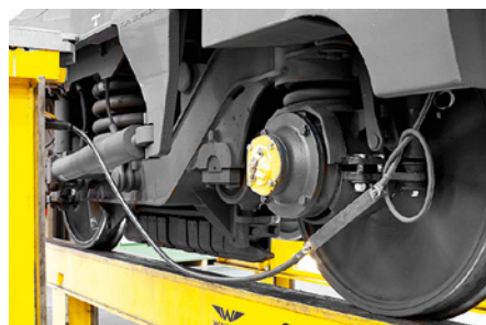
14 Véhicule soulevé et mis à la terre.
