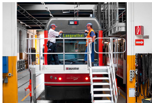
9 Effectuer les travaux de maintenance à partir de plateformes de travail sûres.
