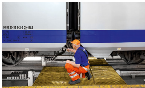
5 Dimension minimale d'élément de couverture de fosse: 1,6 m
