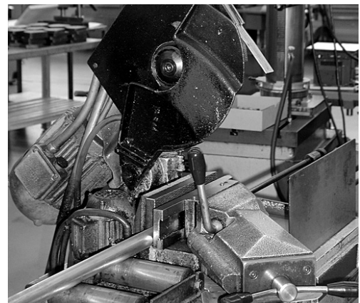
4 Handhebelkreissäge, in der Ruhestellung völlig verdeckt
