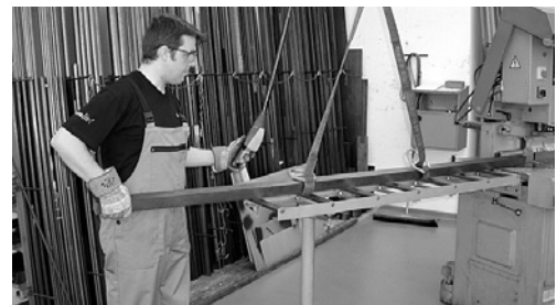
2 Hebezeug zum Beschicken schwerer Werkstücke
