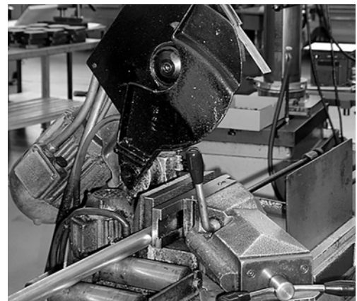
4 Handhebelkreissäge, in der Ruhestellung völlig verdeckt
