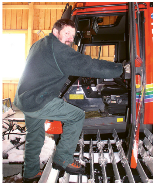
6 Sicheres Auf- und Absteigen: Festhalten und gutes Schuhwerk mit Profilsohle tragen.
