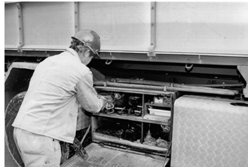
1 Die Zurr- und Anschlagmittel werden in geeigneten Behältern mitgeführt. So sind sie immer griffbereit.
