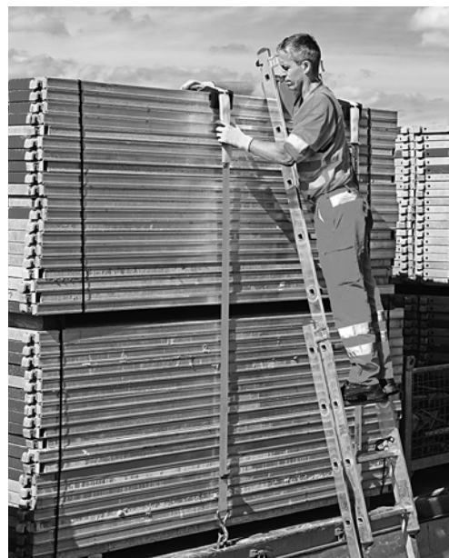
3 Ladungssicherung in der Höhe mit Leiter
