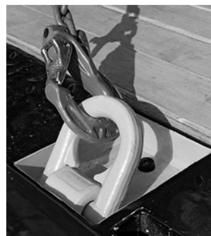
2 Für die Ladungssicherung vorgesehener Zurpunkt
