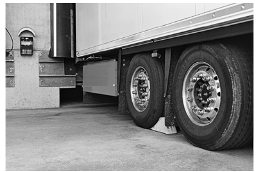
4 Fahrzeug an Laderampen und Ladebuchten mit Radkeil sichern.
