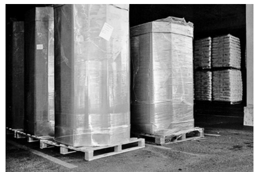
6 Gut gebundene und gelagerte Materialien ermöglichen ein problemloses Aufladen.
