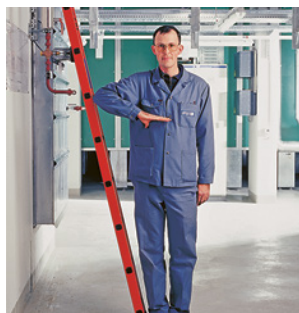
2 Prova del gomito per l'angolo di appoggio (70° circa)
