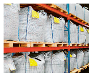
4 Stoccaggio di big bag in un unico strato o in apposite strutture
