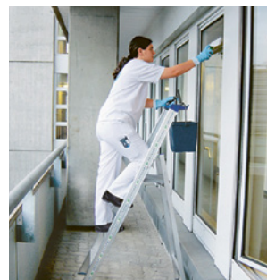
4 Scala doppia con piattaforma di stazionamento e dispositivo di trattenuta
