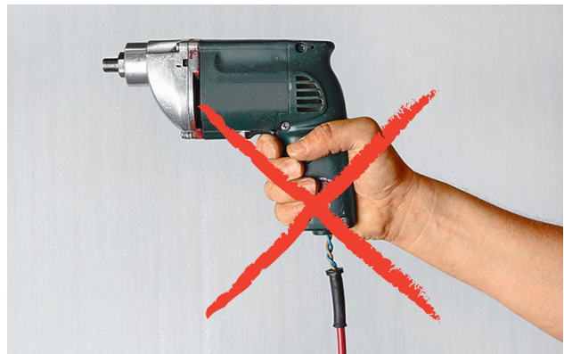
4 Defekte Kabel und Geräte einsetzen lohnt sich nicht.
