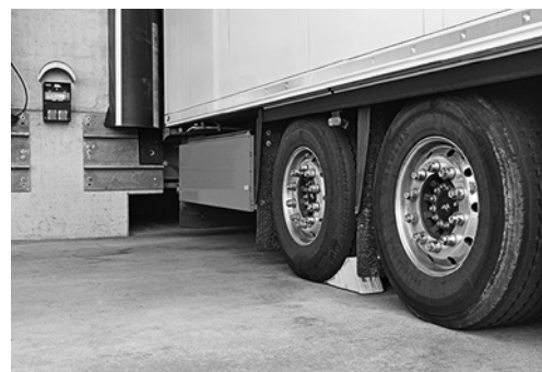
4 Niches et quais de chargement: les roues du véhicule à l'arrêt sont immobilisées au moyen de cales.
