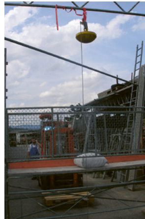
3 und 4: Versuchsaufbau für die dynamische Prüfung
