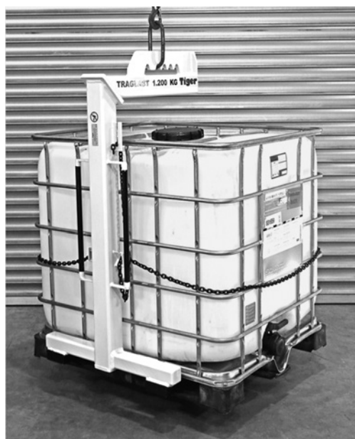
3 Fourche de levage avec chaîne de sécurité utilisée sur un chantier
