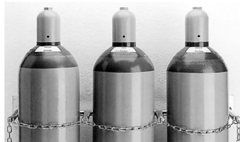
1 Bombole a gas tenute ferme da una catena
