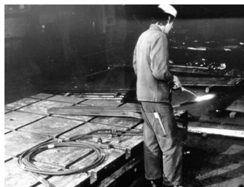
2 Tubi flessibili arrotolati in modo corretto senza rischio di inciampare per il lavoratore
