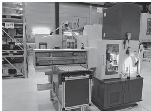
Fig. 4: Les zones dangereuses de la presse et du robot de chargement doivent être correctement protégées.
