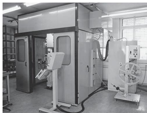
Fig. 1: Presse automatique équipée d'une cabine insonorisante.
