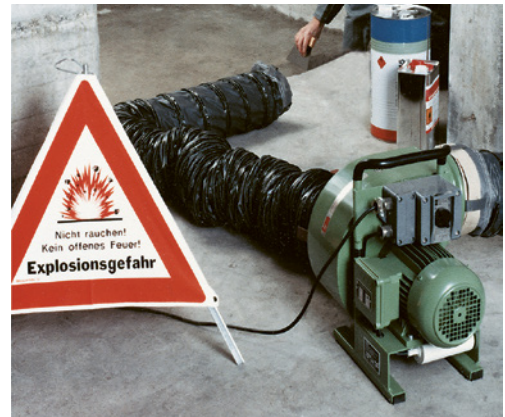
2 Absaugung gefährlicher Stoffe. Auf Baustellen sind explosionsgeschützte mobile Absaugventilatoren einzusetzen.
