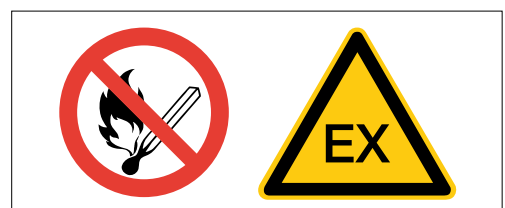
4 Sicherheitskennzeichnung in einem explosionsgefährdeten Bereich.
