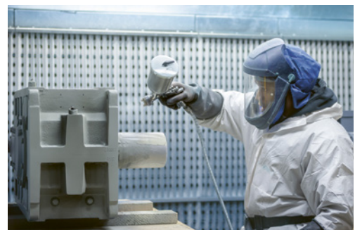
3 Spritzanlage in einem Lackierbetrieb: Die Absaugfläche ist so ausgelegt, dass sich der Mitarbeiter im Frischluftstrom befindet.
