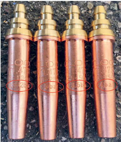
Bild 17 Düse für Schneidbrenner mit eingepprägter Angabe des erforderlichen Sauerstoff-Arbeitsdrucks
