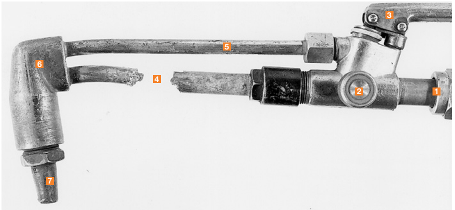
Bild 18 Schneideinsatz mit durchgebranntem Mischrohr.
