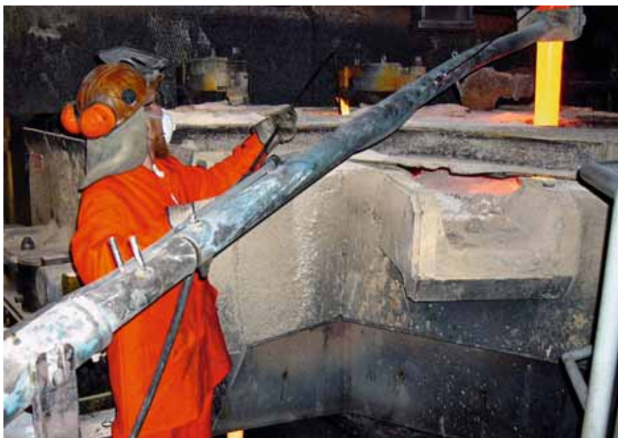
Prélèvement d'échantillon lors de la coulée d'un alliage au plomb.
