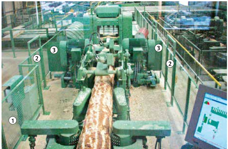
Bild 13: Einzugs- und Zentriereinrichtung vor Parallelzerspanner
