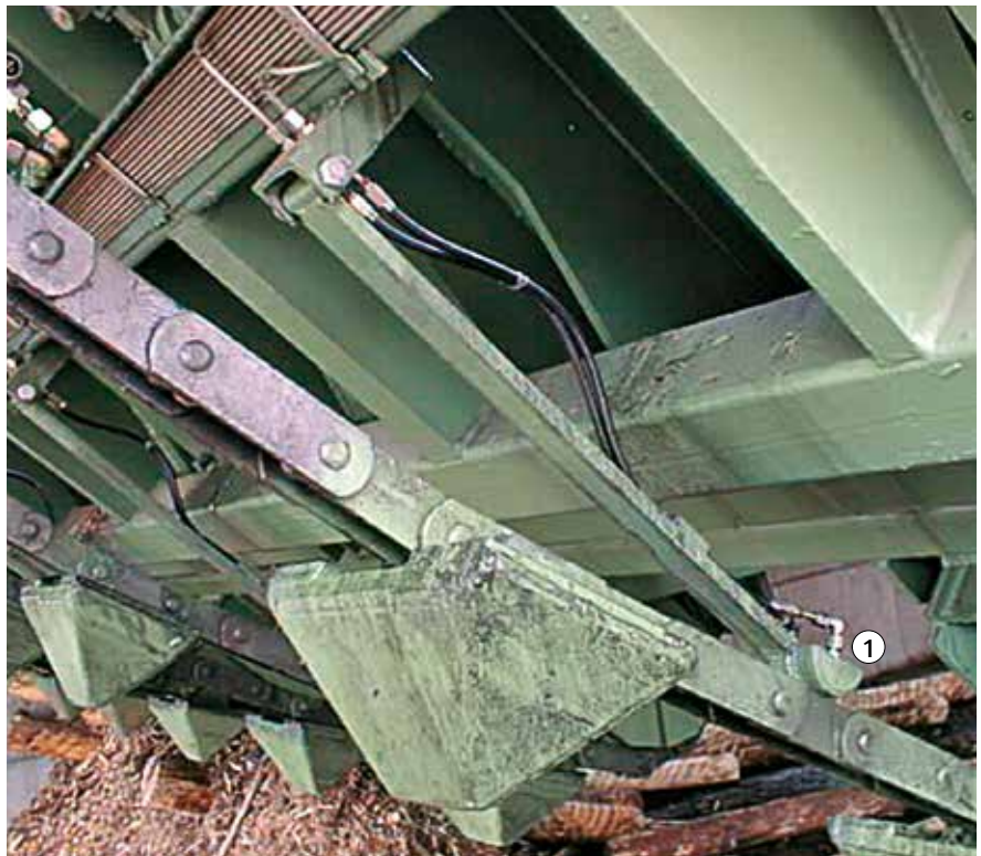
Bild 41: Zentralschmierung am rücklaufenden Kettenstrang eines Einzelners
