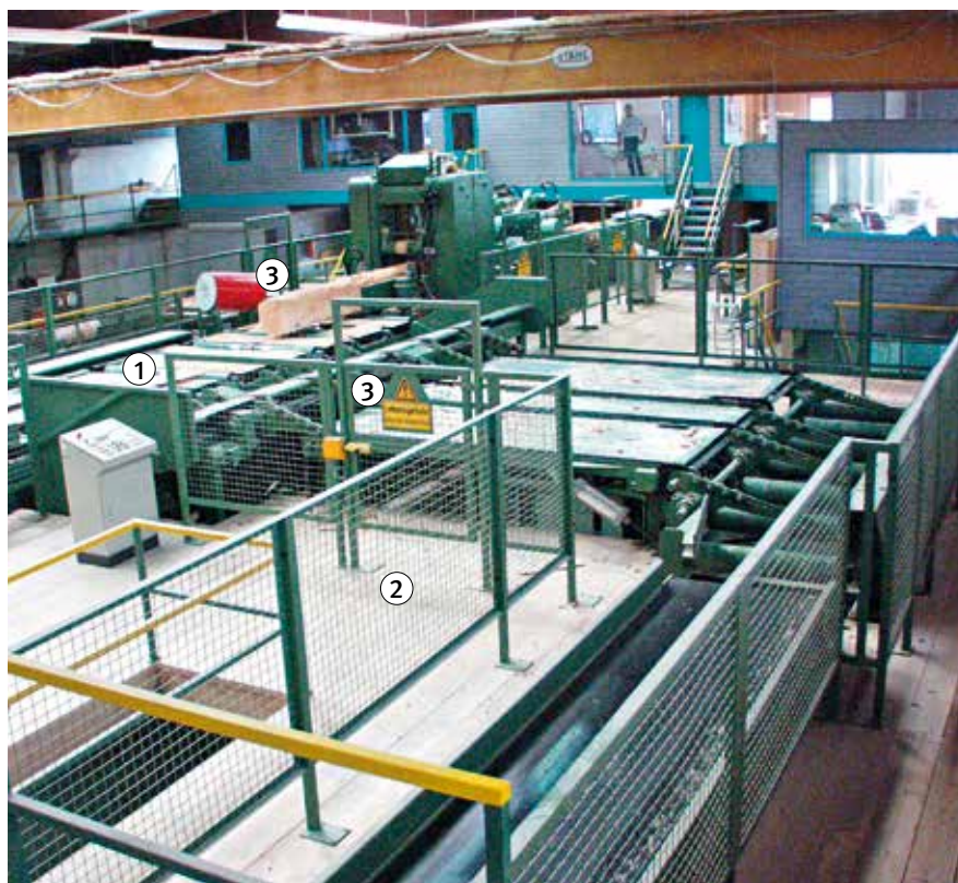
Bild 35: Ausführungsbeispiel Winkelübergabe nach Hochleistungsgatter
