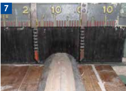
Eine leichtgängige Rückschlagsicherung umschließt das Werkstück lückenlos und verhindert das Heraus-schleudern von Splittern.
