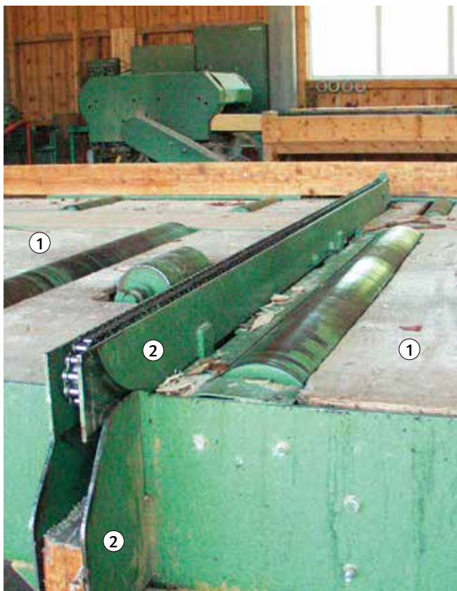
Bild 33: Querförderer als Winkelübergabe im Abzugsrollengang (obere Endstellung)
