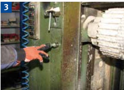
Sicherung der oberen Druckwalze gegen Absinken durch eingesteckten Stift.
