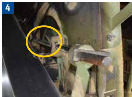
Formschlüssige Sicherung gegen Herabsinken des Sägerahmens.
