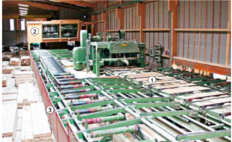
Bild 22: Doppelwellenkreissäge mit Modelrücklauf
