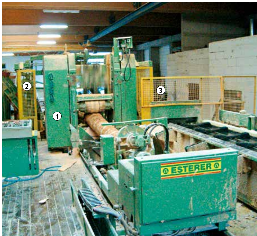
Bild 4: Vertikalgatter mit handgesteuertem Spannwagen und gleisgeführter Steuerkabine
