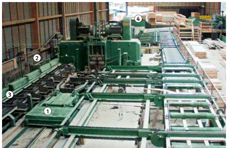
Bild 21: Doppelwellenkreissäge mit Modelrücklauf
