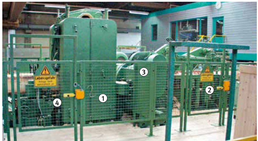
Bild 14: Parallelzerspaner, Hochleistungsgatter und Abzugsrollengang
