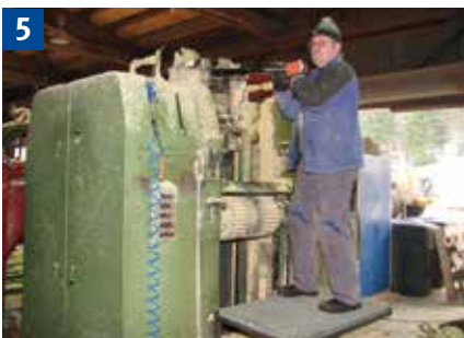
Spannen der Sägeblätter von geeigneter Standfläche aus.
