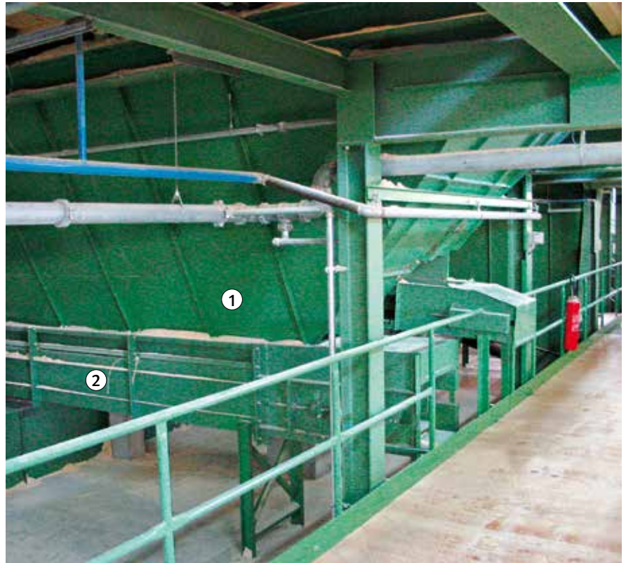
Bild 40: Ausführungsbeispiel Entsorgung Nachschnittsäge
