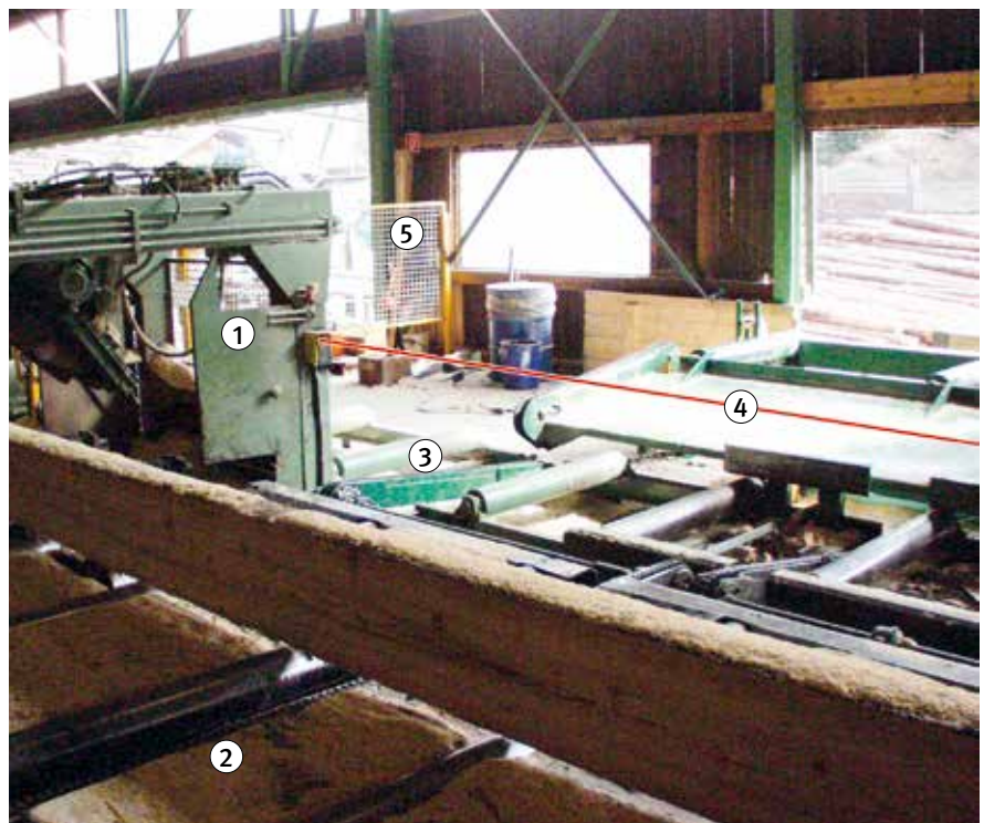
Bild 37: Ausführungsbeispiel Winkelübergabe für Hauptware zur Nachschnittlinie
