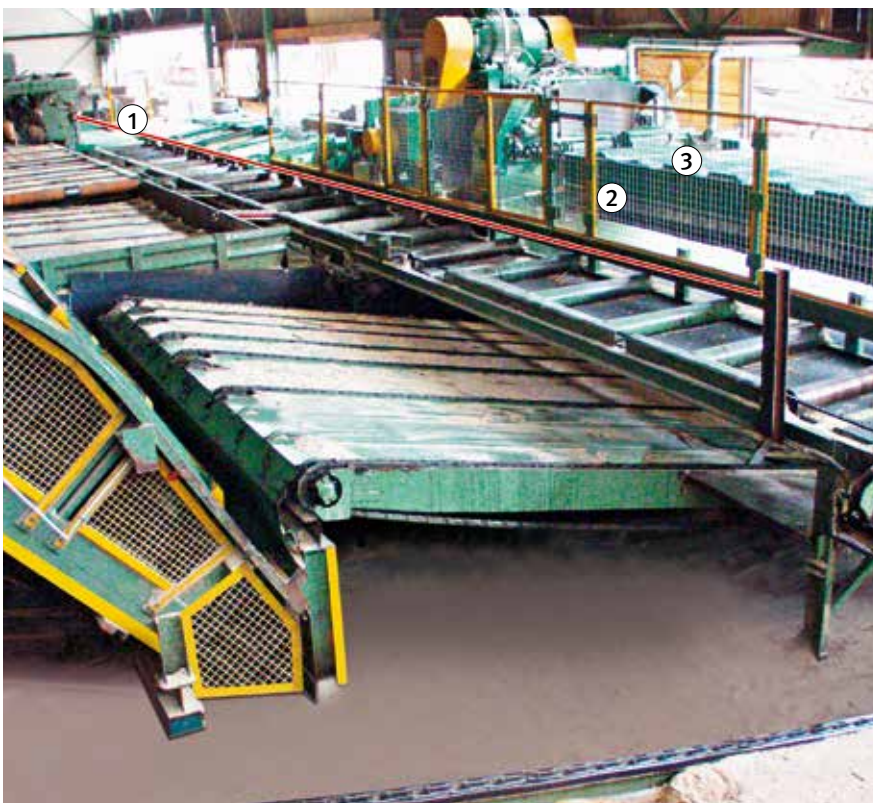
Bild 39: Ausführungsbeispiel eines abgestuften Sicherungskonzepts einer Nachschnittsäge
