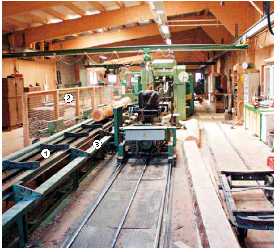
Bild 2: Blockzug und handgesteuerter Gatterspannwagen
