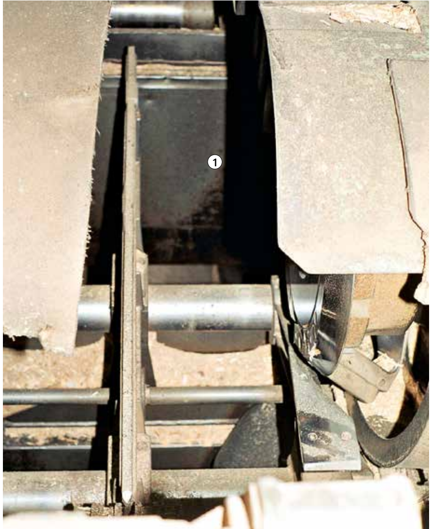
Bild 47: Fehlende Standfläche zum Werkzeugwechsel an einem Spaner
