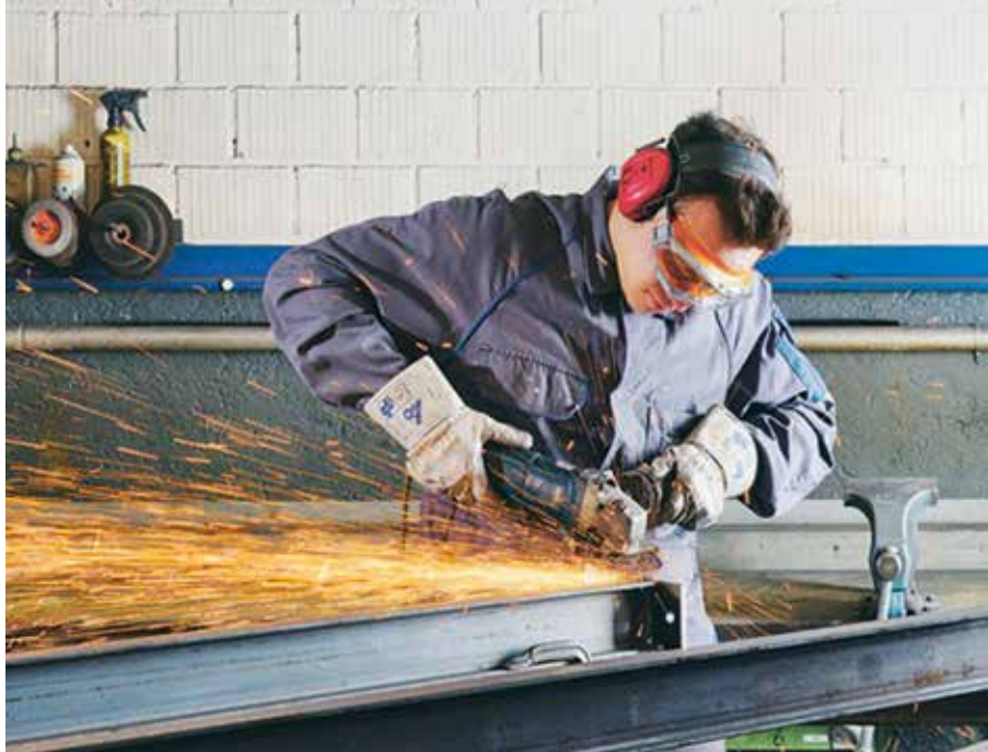
Protection contre le bruit, les étincelles et les projections de copeaux métalliques lors du meulage.
