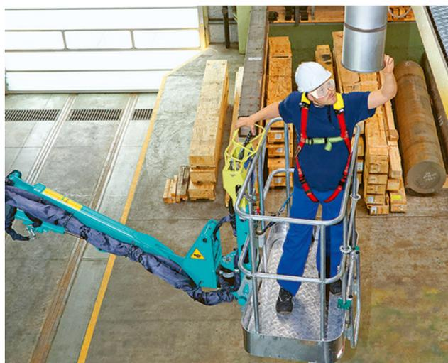
1 PEMP utilisée pour remplacer une ampoule en hauteur.
