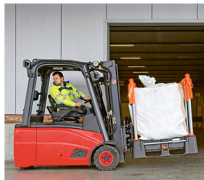
3 Transport d'un big bag sur une palette spéciale.
