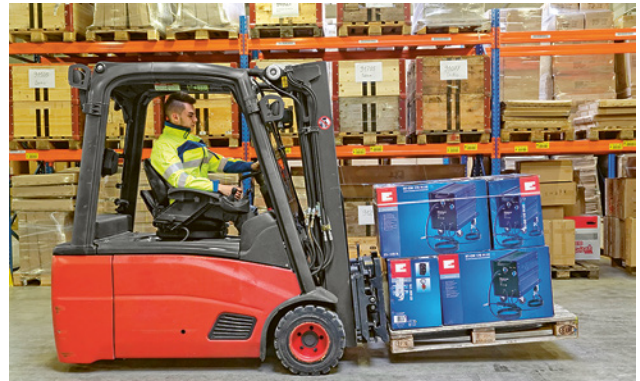
1 Manœuvrer le chariot à partir du siège.
