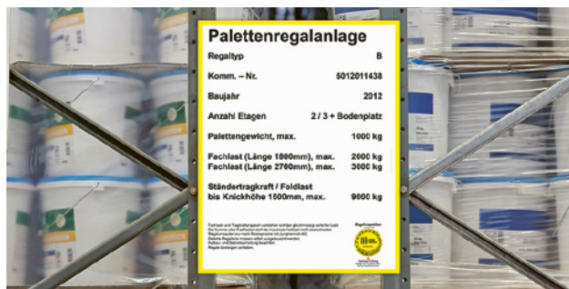
2 Rayonnages: respecter la capacité de charge.
