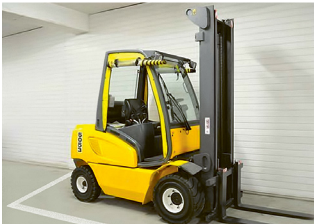
10 Chariot élévateur garé à l'emplacement prévu à cet effet.
