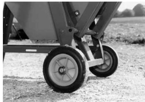
Figura 6: ruote di dimensioni sufficienti per il trasporto e lo spostamento della macchina.
