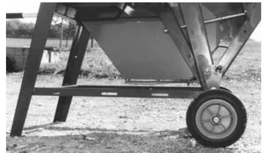
Figura 3: la lama circolare deve essere schermata sotto il portapezzo in modo da impedire il contatto con la dentatura della sega (sporgenza oltre il profilo della dentatura non meno di 15 cm, larghezza massima 10 cm).
