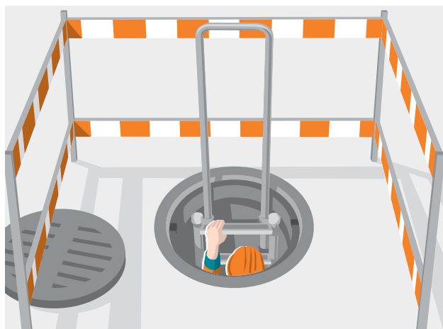
1 Accès sûr à une échelle de regard de visite avec un dispositif d'aide à l'entrée et à la sortie
