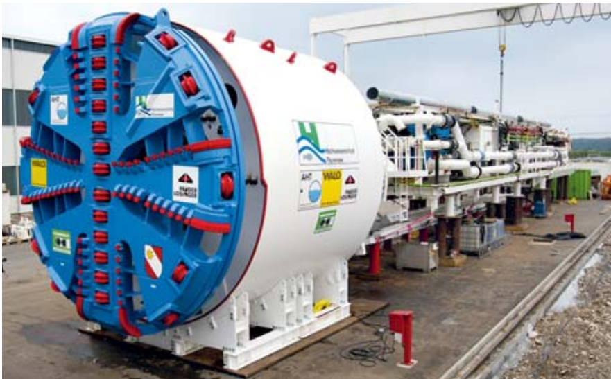
Abbildung 9b Ansicht von vorne gegen das Schneidrad, daran anschliessend weiss gestrichen der Schild und dahinter Teile des Nachläufers (unter Kran), welcher die Installationen für die Maschine und den Rohausbau des Tunnels enthält.
