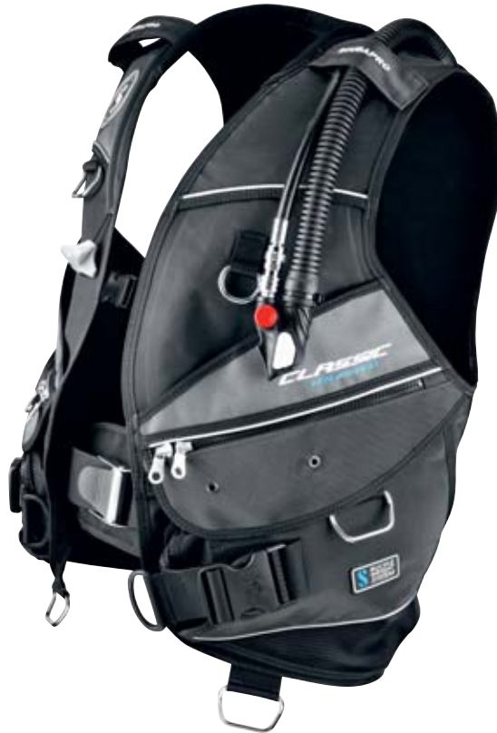
Abbildung 20 Ein wichtiges Element der Sporttaucherausrüstung ist das Stabilizing Jacket. Über den dünnen Schlauch lässt es sich aus der mitgeführten Atemgasflasche (nicht abgebildet) mit Luft füllen. Alternativ kann dies auch über das integrierte Mundstück durch Einblasen erfolgen (Insufflator am Faltenschlauch). Mit dem roten Knopf kann Luft wieder abgelassen werden. Auf diese Weise kann der Taucher in jeder Tiefe seinen Auf- und Abtrieb steuern.
