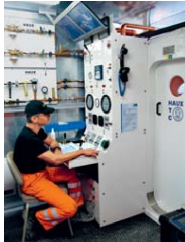
Abbildung 23b Bedienungs- und Überwachungskonsole für den Kammerfahrer.
