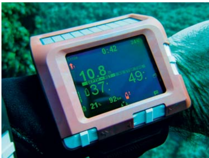
Abbildung 21 Tauchcomputer; ein am Handgelenk getragenes oder am Hochdruckschlauch befestigtes Instrument, das u.a. Tauchzeit, herrschenden Druck bzw. momentane Tauchtiefe sowie verbleibende Atemgasreserve registriert. Gestützt darauf zeigt das Gerät dem Taucher an, bis wann längstens innerhalb der sog. Nullzeit getaucht werden kann bzw. wann welche Deko'stopps einzuhalten sind.
