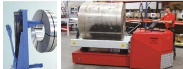
Bild 7 und 8 Mit Dornwagen, Dornstapler oder speziellen Coil-Transportwagen können Bandstahlringe und Coils mit horizontaler Achse sicher transportiert werden.
