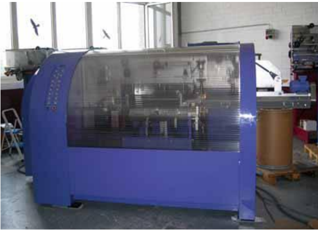
21 Kapselung eines Dosenschweissautomaten. Durch die Kapselung wird der Schallpegel auf der Aussenseite auf 82 dB(A) reduziert.
