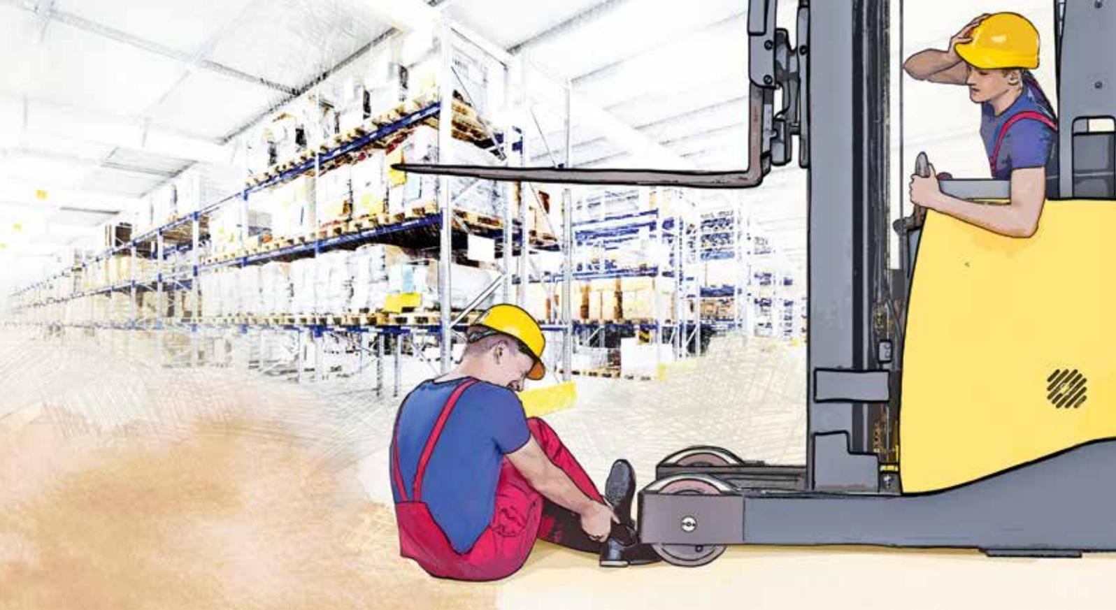
L'utilisation des chariots élévateurs présuppose une formation et une instruction approfondies. Séparer les surfaces de travail des voies de circulation est particulièrement important.
