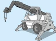
Chariot télescopique équipé d'un treuil
