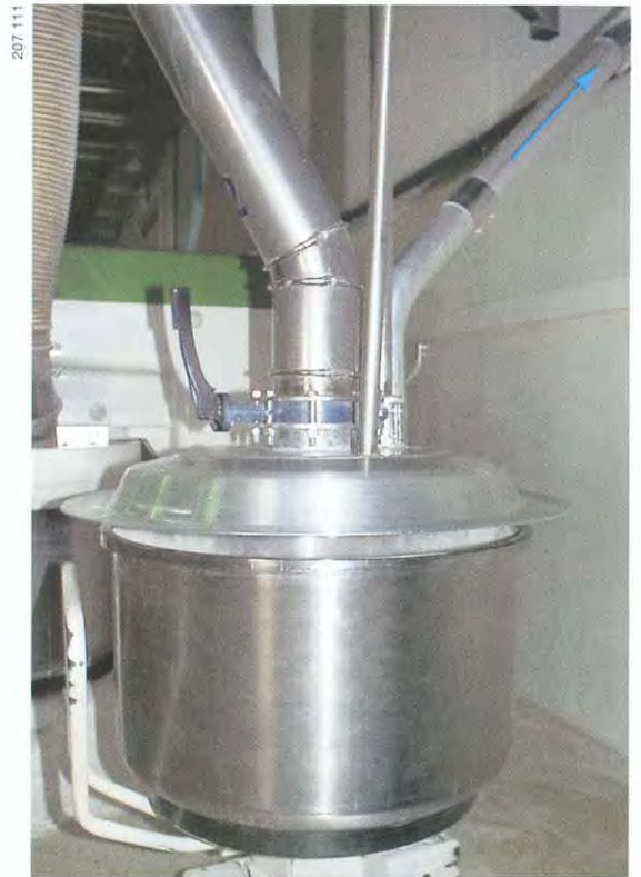
Figure 34 Aspiration optimale lors d'un remplissage de farine
