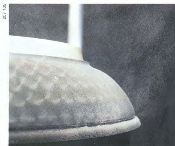
Figure 26 Fuite de poussière d'un pétrin de type «Stefan»
