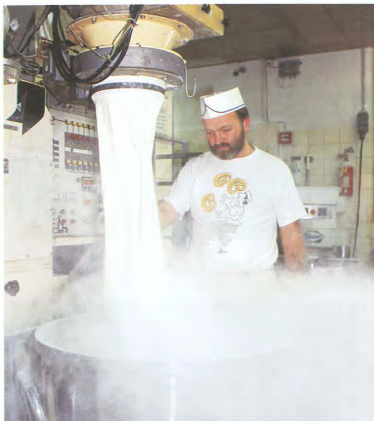
Figure 21 Dégagement de poussière à cause d'un tuyau de remplissage trop court
