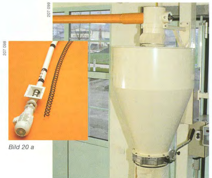
Figure 20 a+b Transport de farine par vis d'Archimède
