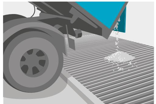
9 Apertura di alimentazione provvista di griglia non destinata al passaggio del personale. La distanza tra le sbarre longitudinali non deve superare gli 80 mm. In caso di presenza di sbarre longitudinali e trasversali, le aperture tra le sbarre devono essere al massimo di 150 x 150 mm.
