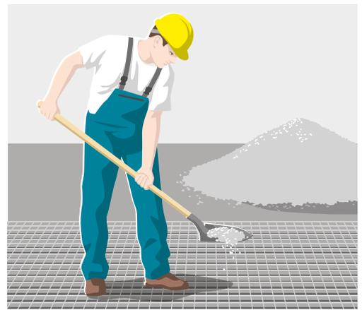
8 Apertura di alimentazione provvista di griglia per il passaggio del personale. Le maglie della griglia devono misurare al massimo 50 x 50 mm.
