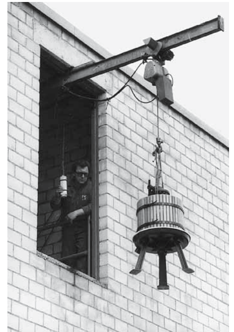
Bilder 5 und 6: Wandöffnung für Warenumschlag mit Hebezeug über Laufschiene ins Freie. Die abgebildete Schiebetüre lässt sich aus einer gewissen Entfernung gefahrlos öffnen und schliessen. Auch das Bedienen des Hebezeugs und die Verständigung mit dem Lastanbinder auf der unteren Ebene ist von einem sicheren Standort aus möglich.
